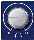
**Phones.** Der Regler Phones steuert die Lautstärke des Kopfhörerausgangs auf der Geräterückseite. Der Kopfhörerverstärker ist relativ leistungsstark und bis 11 skaliert – verwenden Sie die Maximaleinstellung mit besonderer Vorsicht.
